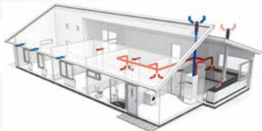
Figur 5.4 Brugsvandsvarmepumpe (som anvender rumluft som varmekilde).
