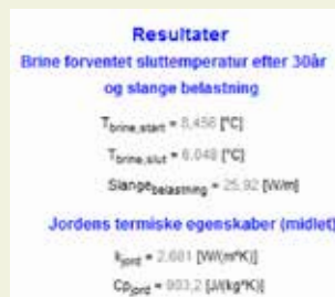
Figur 6.14. Overordnede resultater af den detaljerede beregning. k_{\text{jord}} er varmeoverføringstal og C_{p,\text{jord}} er varmekapaciteten.
